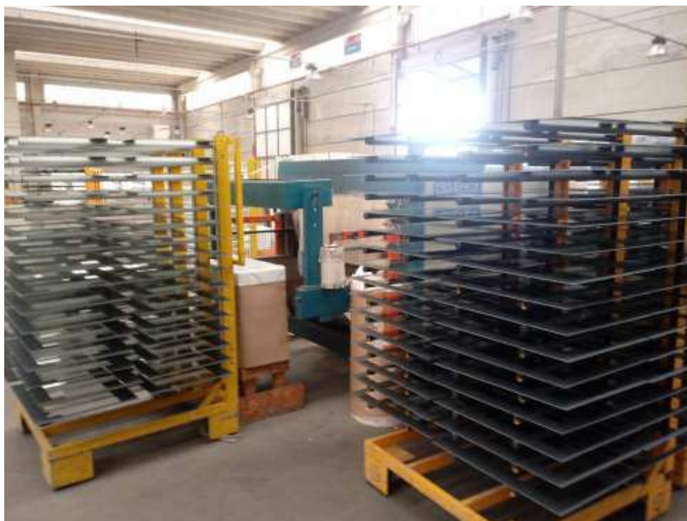
Foto 009: Silk aplicado e produto pronto para o forno.
