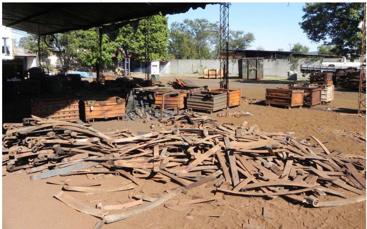
Foto 014: Estoque de sucatas, matéria prima utilizada no processo de fundição
